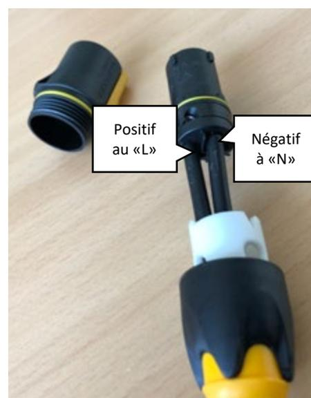
Figure 9 : Polarité du câble solaire
