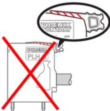
Après le raccordement à une borne, le câble doit être fixé aux pignons de fixation à l'aide d'un serre-câble.
