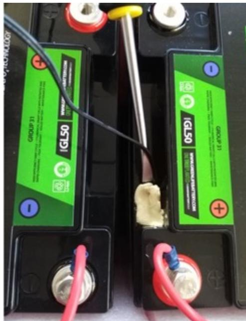
Figure 26: Enlever le capteur de température
