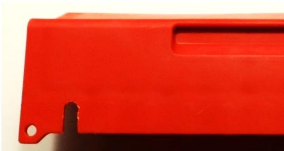
*Figure 16 : Découpe d'un volet de protection des bornes pour y faire passer un câble*
