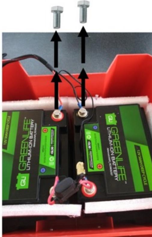
Figure 25: Desserrer les vis des câbles de la batterie
