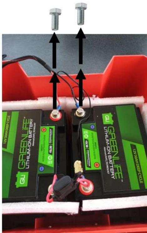
Abbildung 13: Lösen der Schrauben von den Batteriekabeln
