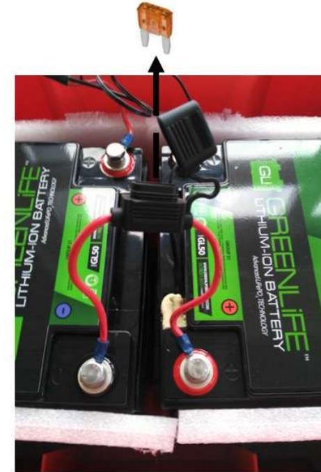
Abbildung 12: Entnehmen Sie die Sicherung
