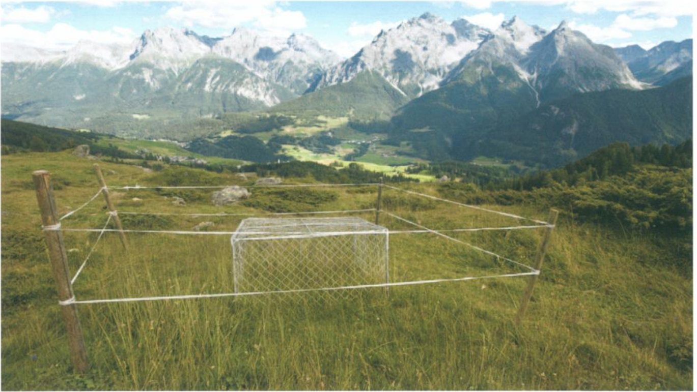
Weideausschlusskorb im Forschungsprogramm AlpFUTUR zur Messung des Futteraufwuchses auf der Alp Laret, Gemeinde Ftan GR. (G. Brändle, Agroscope)
